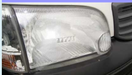
内部リフレクタの劣化
