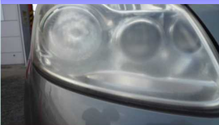
レンズ表面の劣化
